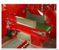
Транспортер сортировки ягод — (возможность снятия) для очистки собранных плодов обслуживающим персоналом комбайна
