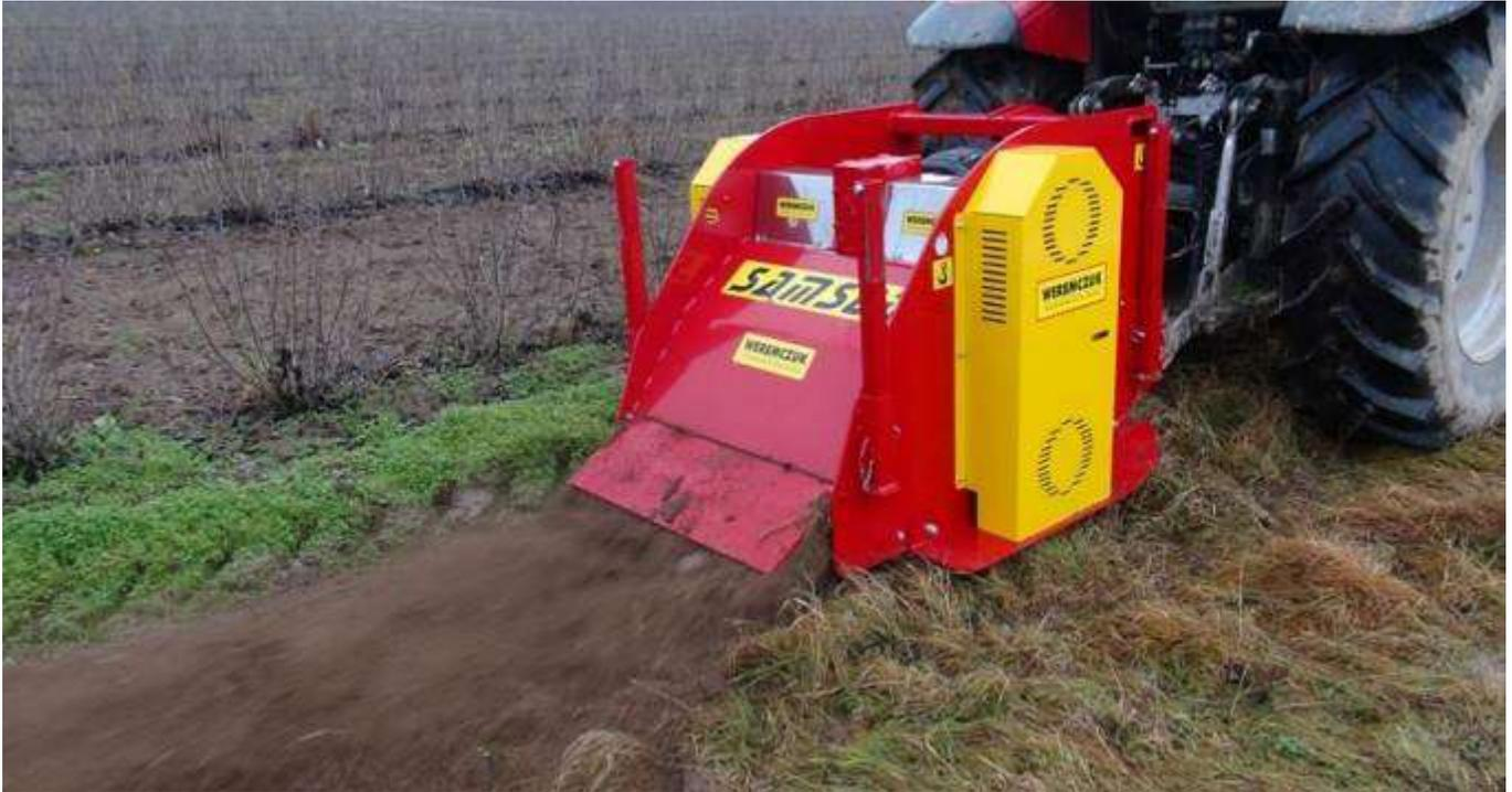
Корчеватель "SAMSON" предназначен для тщательного измельчения и уничтожения корневой системы кустов после предыдущей срезки их надземной части при помощи, например косилки-дробилки.
